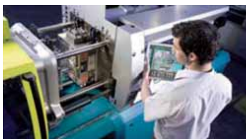
Czterokolumnowy układ zamykania z napędem hydraulicznym po stronie jednostki wtryskowej
