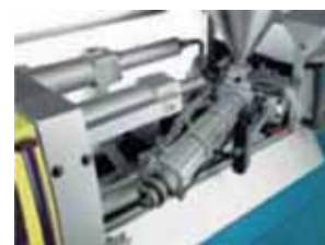
Wychylna jednostka wtryskowa ułatwia przezbieranie i prace konserwacyjne.
