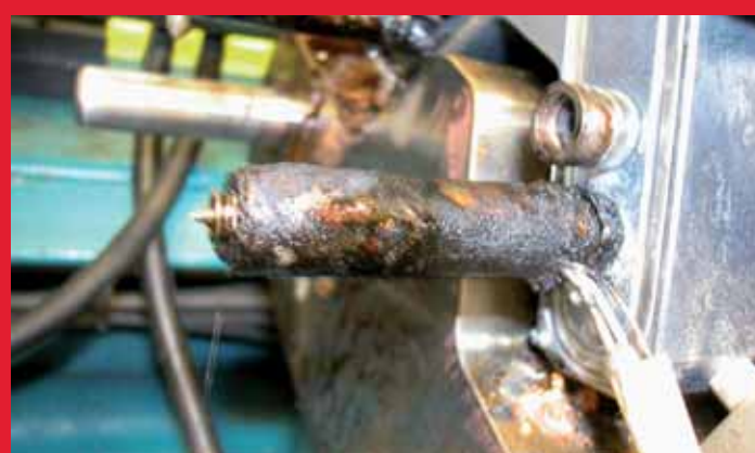
Rys. 7 Zalanie systemu tworzywem spowodowane uszkodzeniem uszczelnienia (styk tulejki centrującej z komorą) w obszarze przewężki dla dyszy uproszczonej
