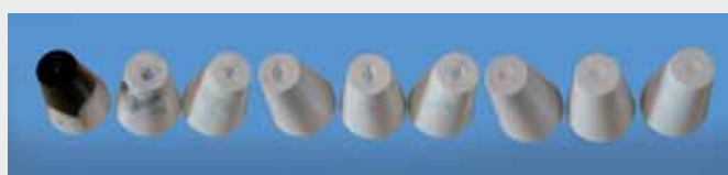
Rys. 5. Zmiana koloru przy zastosowaniu dyszy z końcówką „Mikser” następuje po około 10 cyklach. (Zmiana koloru z czarnego na biały, materiał PS)
