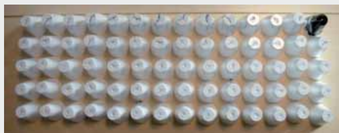
Rys. 3. Zmiana koloru przy zastosowaniu dyszy tradycyjnej (zmiana koloru z czarnego na biały)
